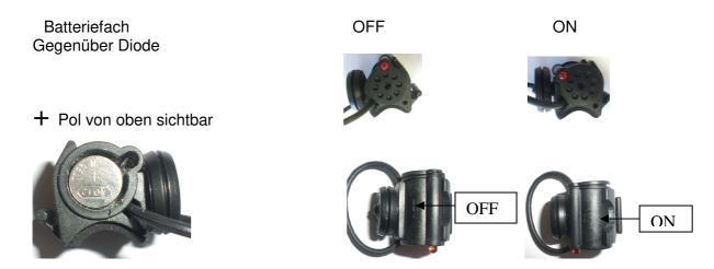
Befestigen Sie den Bissanzeiger mit dem Spanngummi am Rutenblank, legen Sie die Schnur über das Schnurlaufröllchen. Sobald ein Fisch anbeisst und das Schnurlaufröllchen durch abziehende Schnur in Bewegung gesetzt wird, ertönt ein Signalton und die LED leuchtet. Bei längerem Nichtgebrauch sollten die Batterien entfernt werden um das Gerät vor auslaufender Batteriesäure zu schützen.
