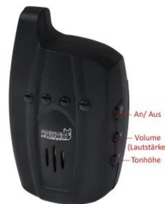
An der Sounderbox wurden alle Einstellmöglichkeiten seitlich angebracht. Sie können zwischen AN/AUS, Volumen (Lautstärke) und Tonhöhe auswählen und durch kurzes Drücken der jeweiligen Taste die gewünschte Einstellung anpassen.
