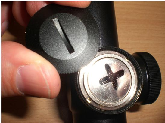
Leuchteinheit mit Batteriefach und eingelegter Batterie CR2032 mit Pluspol oben.
