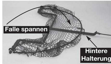
2. Die Falle jetzt spannen und mit der hinteren Halterung sichern.
