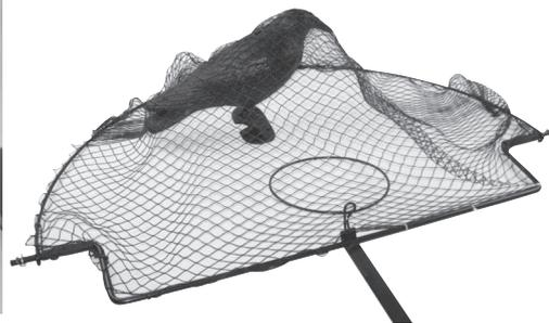
6. Lockmittel unter dem Spannring platzieren, sobald der Spannring verschoben wird schnappt die Falle zu.
